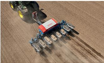
„Die ValoTerra Ultimate wurde speziell für die Aussaat bei Arbeitsgeschwindigkeiten von 2 bis 18 km/h entwickelt: Sie kann das Leistungsniveau sowohl bei hohen als auch bei niedrigen und mittleren Geschwindigkeiten halten, die Sortenvielfalt steuern und bei hohen Geschwindigkeiten die gewünschte Menge Dünger ausbringen“, erklärt Monosem.
